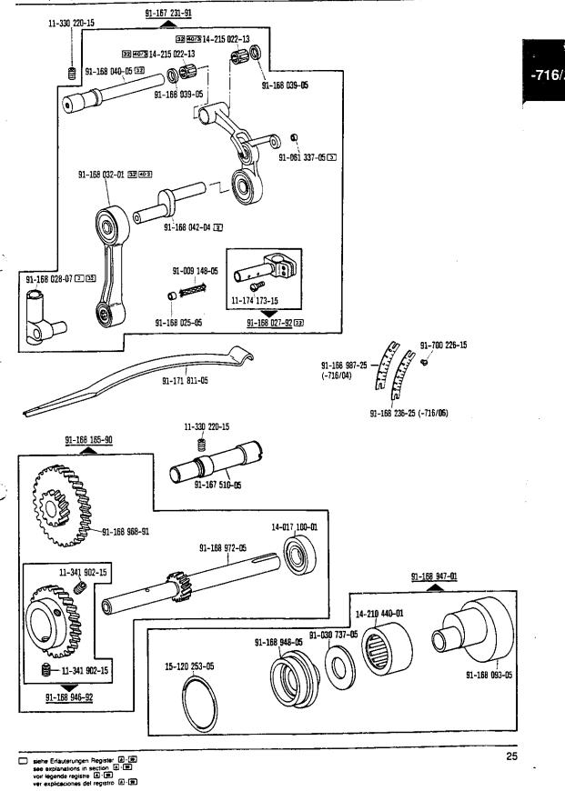
Zick Zack-Steuerung Zig zag control Commande du point zigzag Mando para puntada zig zag -716/04; -716/06
