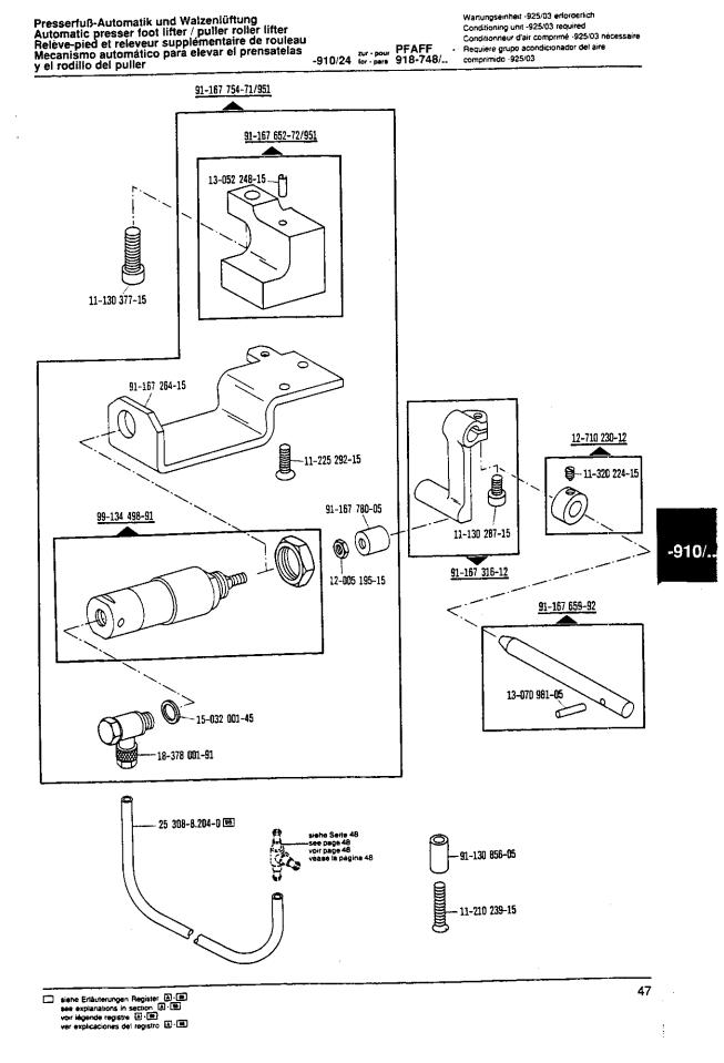
Presserfuß-Automatik und Walzenlüftung Automatic presser foot lifter / puller roller lifter Relève-pied et releveur supplémentaire de rouleau Mecanismo automático para elevar el prensatelas y el rodillo del puller
