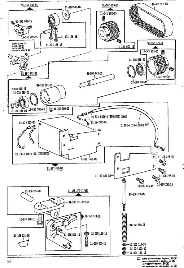
Grundplattenteile Bedplate parts Pièces du plateau fondamental Piezas de la placa-base PFAFF 918
